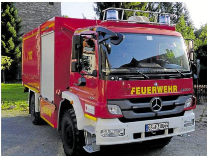
Der SW-KatS – Schlauchwagen für den Katastrophenschutz mit 2000 Metern Schlauch.
