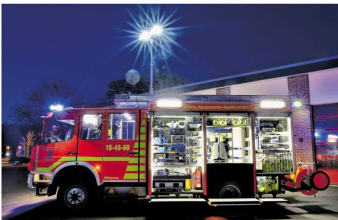
**Das neue HLF 20 ist Arbeitstier und Erstangreifer der Bad Harzburger Feuerwehr. Das Fahrzeug rückt zu annähernd jedem Einsatz mit aus und ist sowohl für die Brandbekämpfung als auch für die Technische Hilfeleistung umfangreich ausgestattet.**
