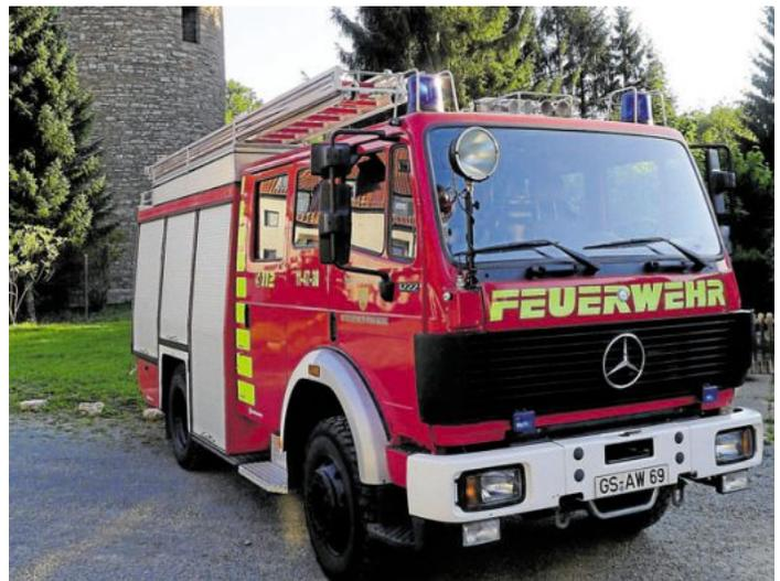
Das Arbeitstier: das LF 16/12 mit einer Feuerlöschkreiselpumpe 16 und 1200 Litern Tankinhalt.
