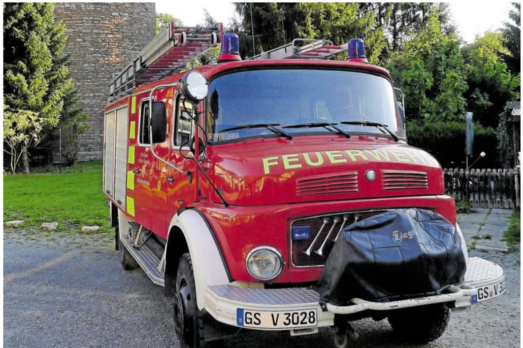
Der Vorgänger des LF 20 KatS: Das LF 16-TS (Löschgruppenfahrzeug mit Vorbaupumpe 16 und Tragkraftspritze) ist ein „Allroundfahrzeug“.
