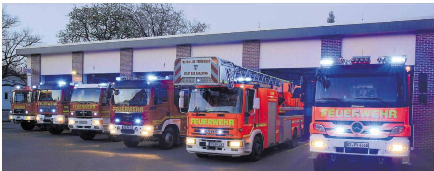
Die beiden Lösch- und Hilfeleistungszüge der Bad Harzburger Feuerwehr mit eingeschaltetem Sondersignal: LF 16, RW, TLF 4000, LF 10/20, DLA (K) 23/12 und HLF 20 (von links).
