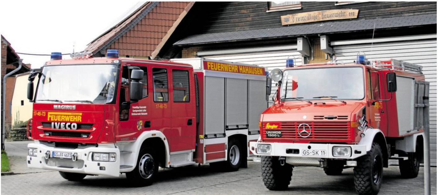
Der Fuhrpark der Feuerwehr Hahausen: Tanklöschfahrzeug (TLF) und Löschfahrzeug mit Hilfeleistungssatz (HLF).
